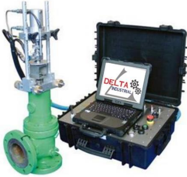
Calibración de valvulas de seguridad en línea-LAD
