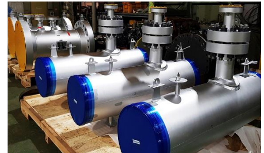
Atemperadores de Vapor
